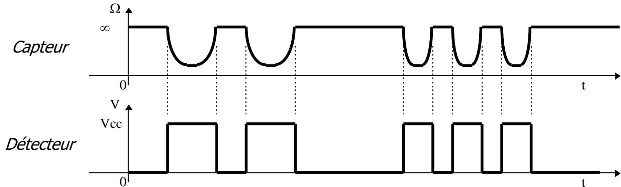
**Capteur RES2 :** Sa section est trapézoïdale. Sa longueur est adaptée à la demande du client ainsi que la longueur du câble de liaison. Dans un même capteur, il est possible d'avoir 2 éléments sensibles ou bien des parties actives et d'autres inactives. Aucun élément métallique ne se déplace, ni se déforme à l'intérieur du capteur. Sa résistance électrique au repos est supérieure à **1 M $\Omega$**  et lorsqu'il est activé, elle est inférieure à **200 K $\Omega$** .
