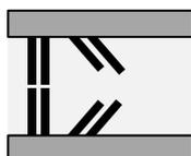
Détection des essieux des VL, PL et motos + détection des roues jumelées des PL + Détection des véhicules qui reculent.
